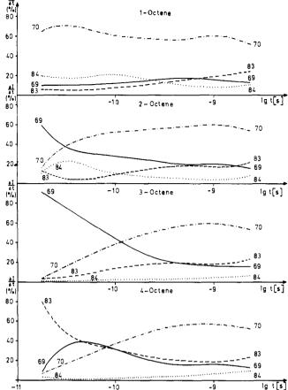
**Figure 2.** Relative rates of formation of  $[C_5H_9]^+$  (*m/e* 69),  $[C_5H_{10}]^+$ . (*m/e* 70),  $[C_6H_{11}]^+$  (*m/e* 83), and  $[C_6H_{12}]^+$ . (*m/e* 84) as function of the ion lifetime for 1-, 2-, 3-, and 4-octene.
